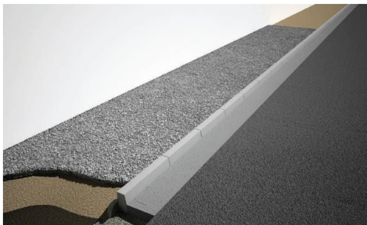
Imagem: Etapa de execução de calçada lançamento do lastro de brita. Fonte: Calçada de concreto moldado “in loco” – PMSP – REV.0 MAR. 2008
