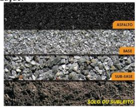
Imagem 01 – Representação das camadas sequenciais e gradativas que integram uma seção típica de pavimentação asfáltica.
