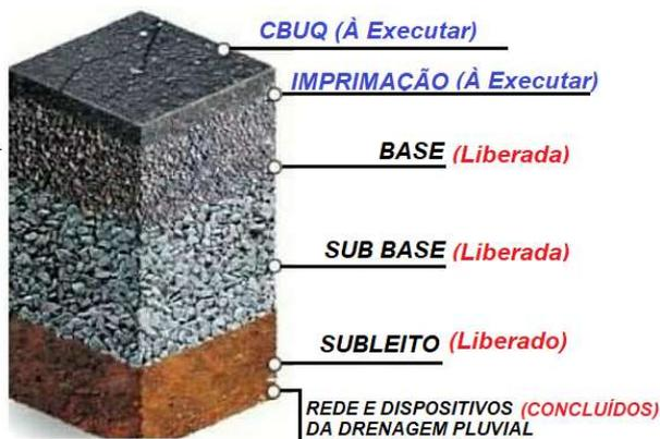
Todas as intervenções na rede e nos dispositivos de drenagem pluvial pública, assim como as camadas inferiores, (a depender do estágio de cada uma das vias selecionadas), de modo geral, camadas do **sub leito, sub base e a camada de base, todas obrigatoriamente deverão estar concluídas e liberadas pela Equipe de Fiscalização**, para a execução apenas da **imprimação e da camada asfáltica final**, objeto deste Termo.
