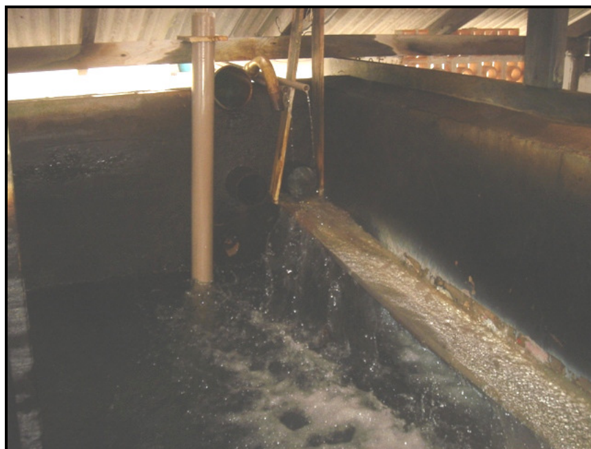
Figura 38 – Adição de Hipoclorito de Sódio
