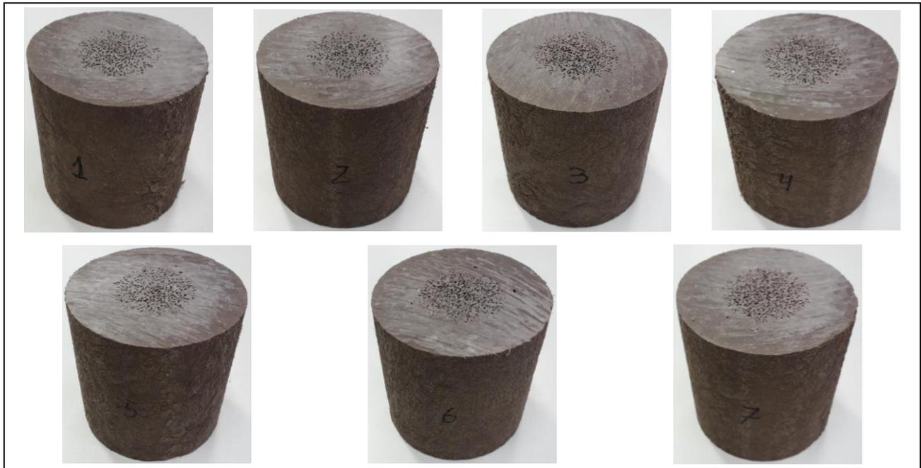
**Figura 1 –** Corpos de prova fornecidos para o ensaio de compressão
