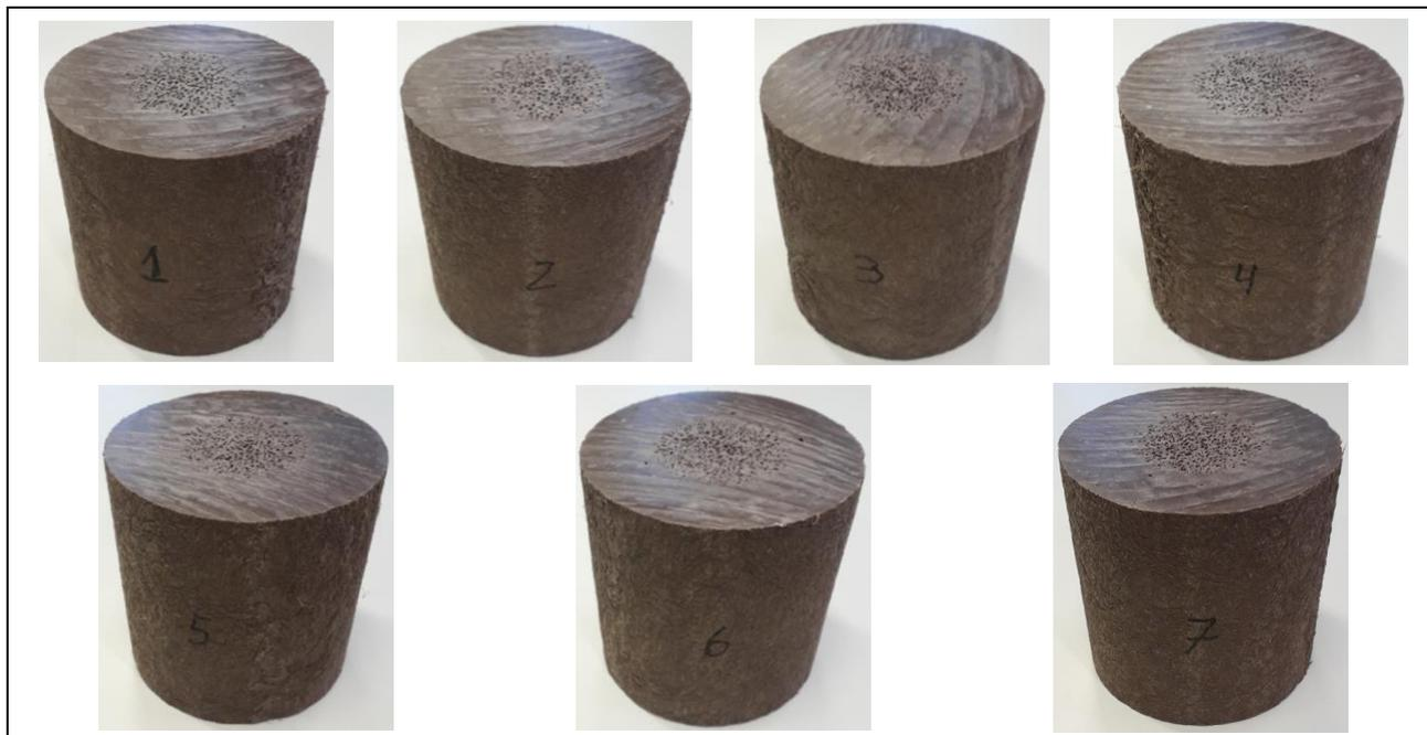
Figura 3 – Corpos de prova após o ensaio de compressão
