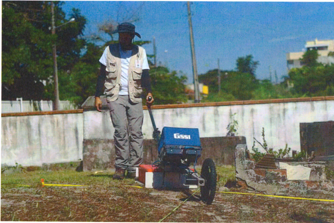
Figura 13: Utilização de equipamento de GPR para penetração de solo.
