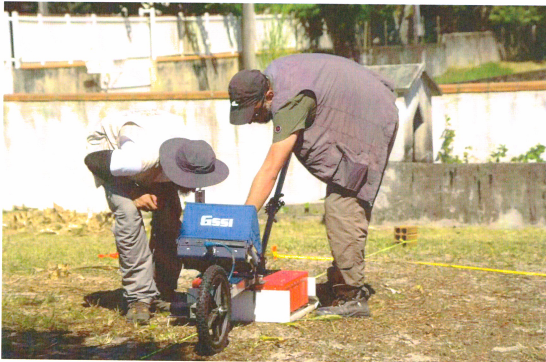
Figura 14: Utilização de equipamento de GPR para penetração de solo.
